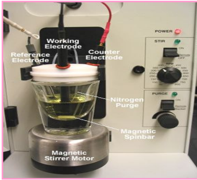
Şekil 3.4. Elektrokimyasal çalışmaların yapıldığı hücre
