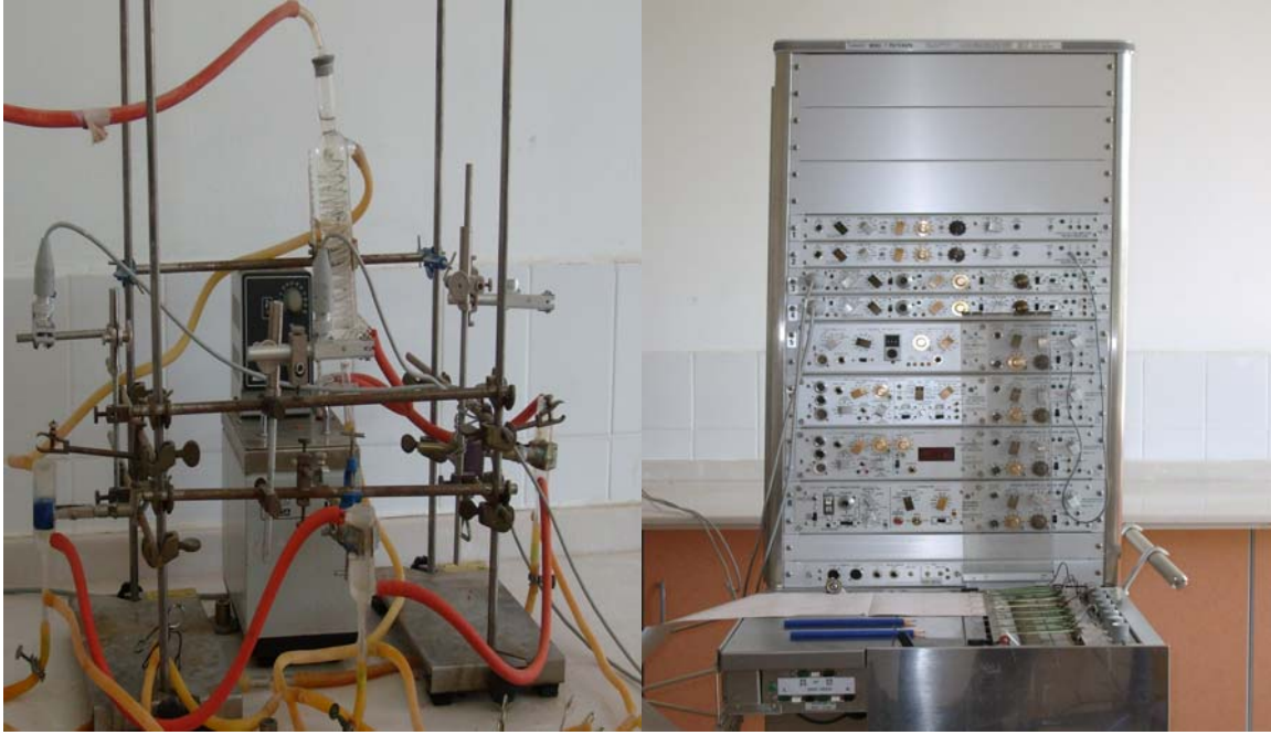
Şekil 3. İzole Organ Banyosu Sistemi, Grass FT. 03 gerim transdüseri ve Grass Model 7 Poligraf.
