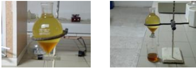
Şekil 4. 3. Biyodizelin Gliserinden Ayrılması Esnasında Fazların Görünümü
