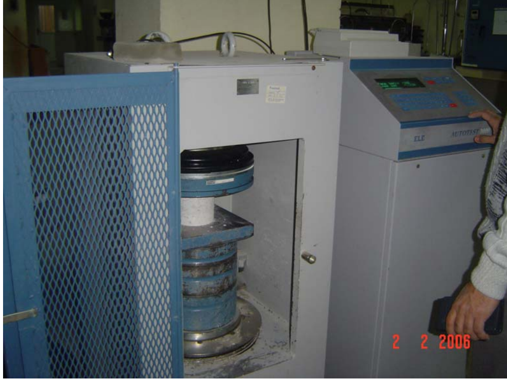
Resim 4.7. Beton basınç presi ve numunelerin deneye tabi tutulması
