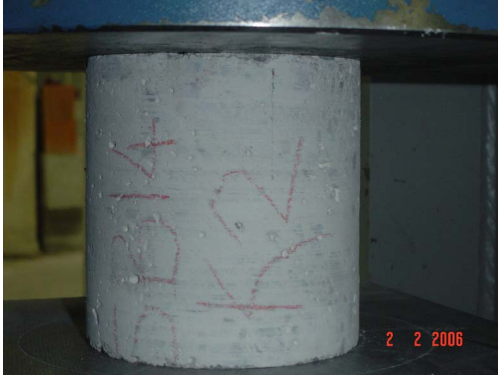
Resim 4.8. Bodrum kat kolonundan alınan numunenin deneye tabi tutulması
