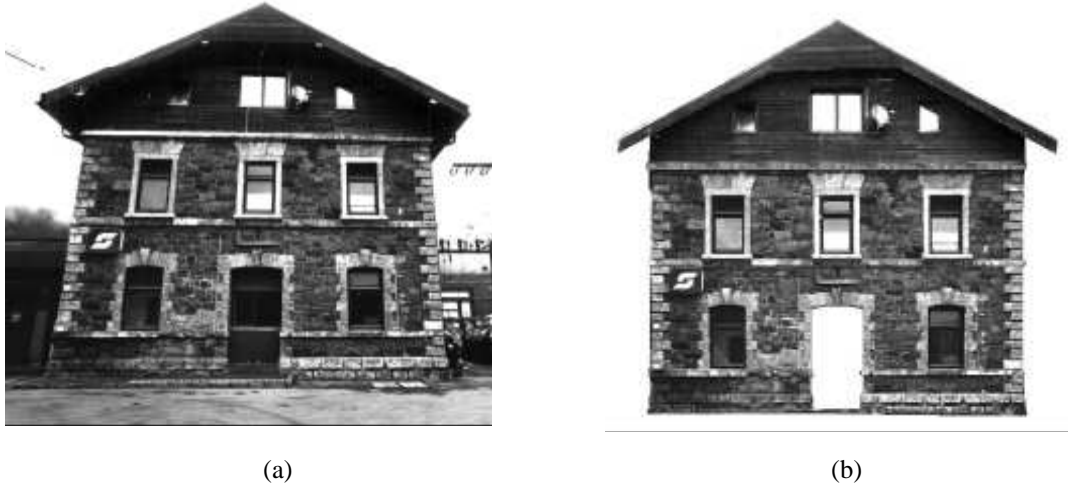
Resim 5.8: (a) Orijinal Fotoğraf (b) Ölçekli Düzeltilmiş Fotoğraf ortofoto
