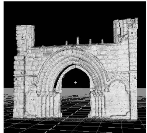
Resim 5.13: Tynemouth Priory, Güney kapısı nokta bulutu detayı ve taranmış modeli (Mills ve Barber 2003).
