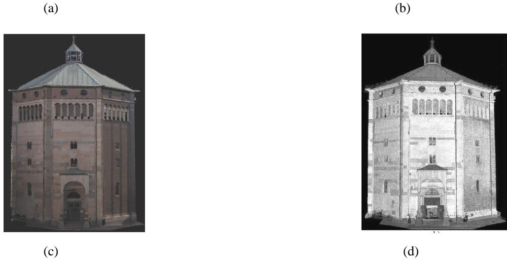
Resim 5.4: (a) Baptistry Katedrali- İtalya (b) fotomodeler yazılımında hazırlanmış modeli (c) lazer tarayıcı ile elde edilmiş katı model (d) lazer tarayıcı modelin fotoğraf dokusu ile kaplanmış modeli – (Conforti Andreoni ve Pinto 2004)
