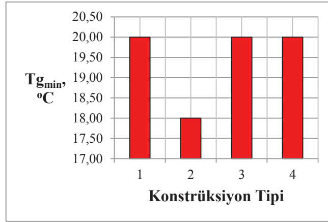
Şekil 6.99. Konstrüksiyon tiplerine göre en düşük kazan su giriş sıcaklık değerleri
