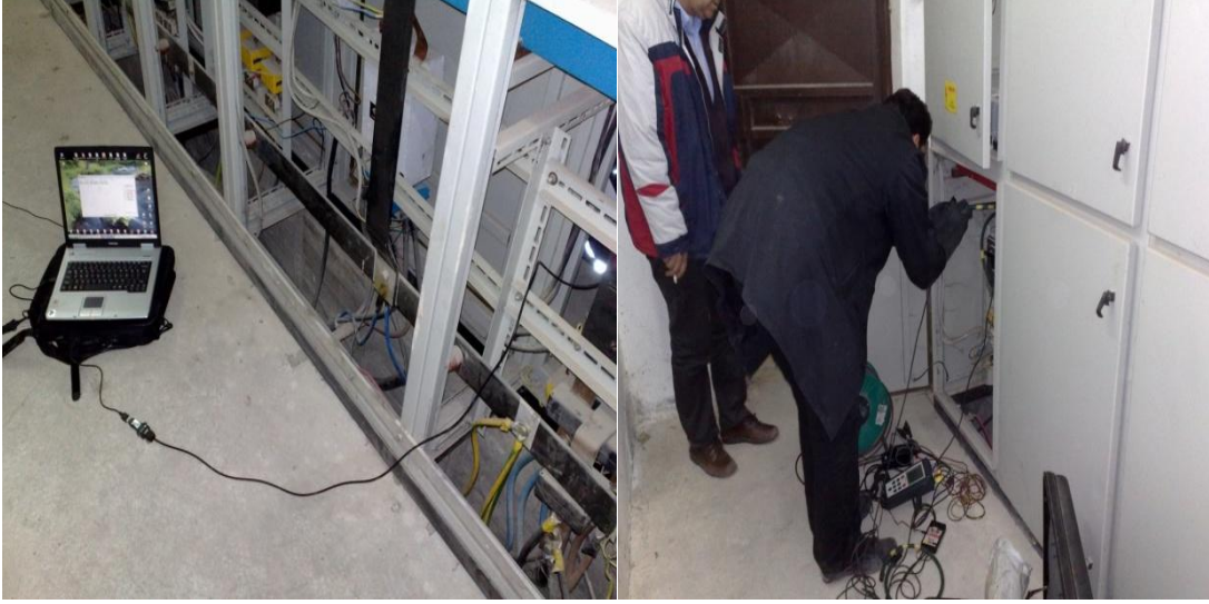
Resim 7.2. Tek fazlı güç analizörünün bilgisayar bağlantısı ve ölçüm cihazının baralara bağlanması (RUDOLF PAK 5 üç fazlı güç analizörü).
