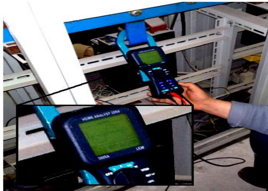
Resim7.1. Baralarda yapılan ölçümler (ANALYST 2060 tek fazlı güç analizörü).
