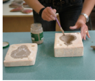
Resim 31 a-b: (a) Cidar kalınlığına çentik açılması, (b) Çentiklenmiş yüzeye balçık sürülmesi.
