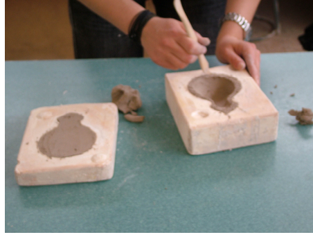
Resim 31 a-b: (a) Cidar kalınlığına çentik açılması, (b) Çentiklenmiş yüzeye balçık sürülmesi.
