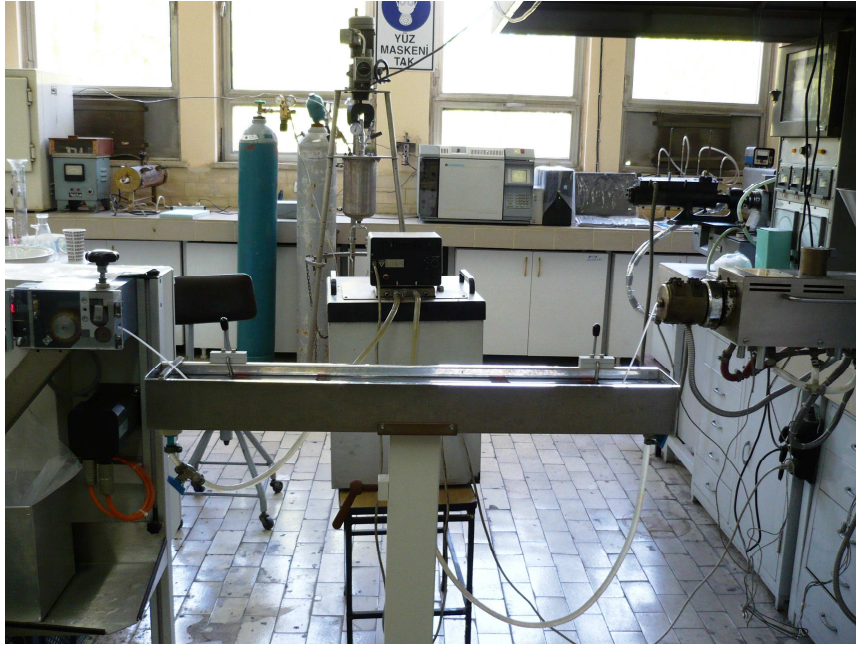
Resim 5.4. Ekstruderden çıkan malzemenin soğutulduğu havuz
