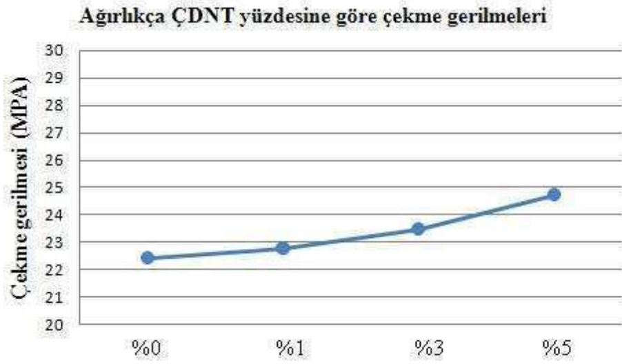
Grafik 5.1. Sıcak presle üretilmiş levhaya ait numunelerin çekme testi sonuçlarının grafiği
