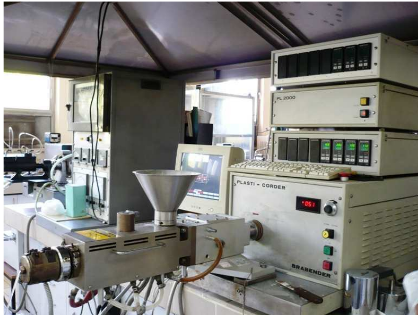
Resim 5.3. Çift vidalı ekstruder ve malzemenin çıkışı
