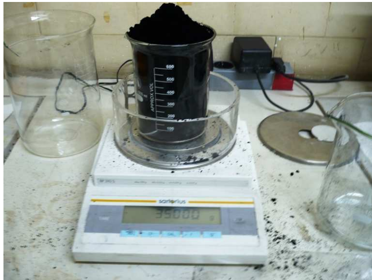
Resim 5.1. Çok Duvarlı Karbon Nanotüplerin hassas olarak tartılması
