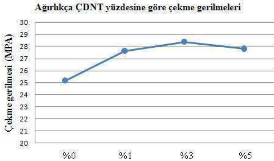
Grafik 5.2. Plastik enjeksiyonla üretilmiş numunelere ait çekme testi sonuçlarının grafiği
