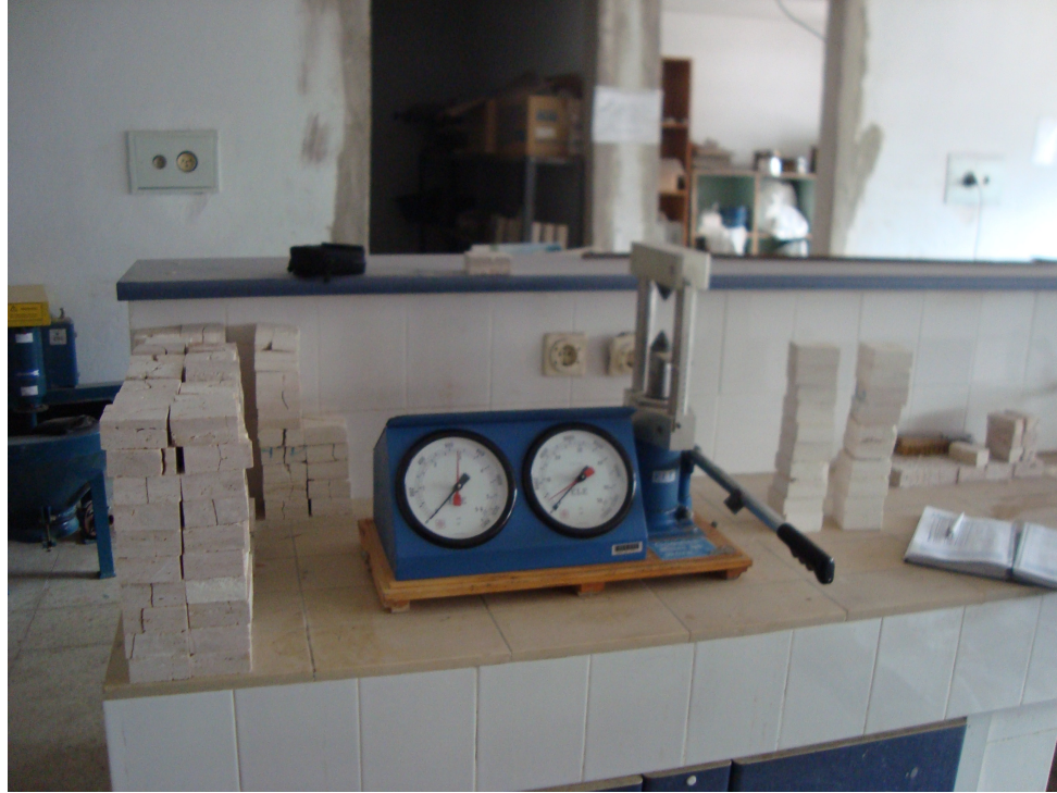
Şekil 3.9 Nokta yükleme deneyinin uygulanaşı.
