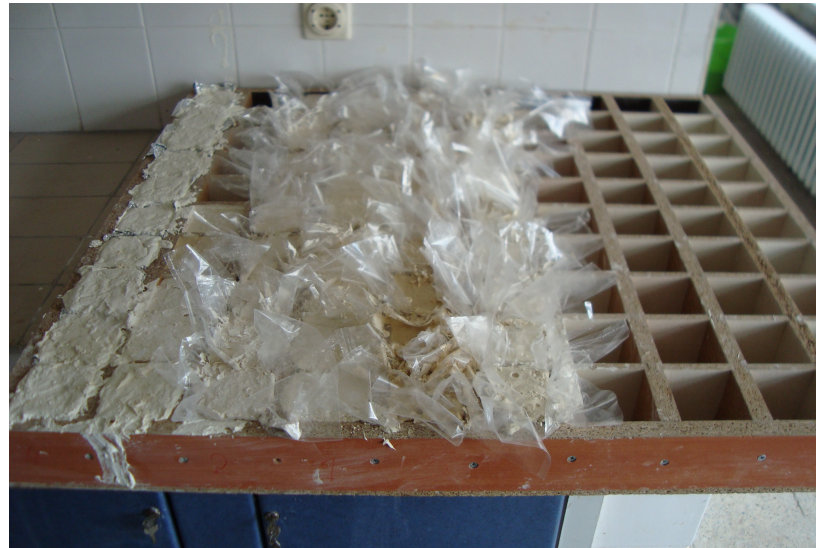
Şekil 3.15 Yapay küpler için hazırlanan kimyasalların 7 \times 7 \times 7 \text{ cm}^3 lük kalıba uygulanışı.
