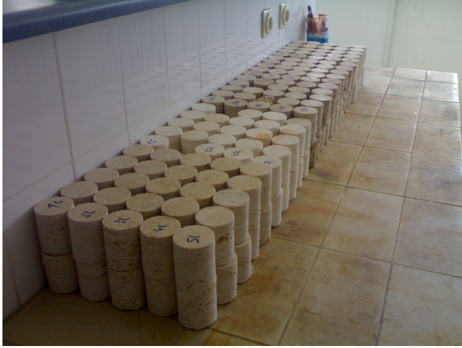
Şekil 3.21 Brazilian deneyinde kullanılmak üzere hazırlanan karot numuneleri.
