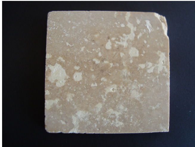
Şekil 4.20 (7. Karışım Uygulanmış Latte Traverten numunesi.)
