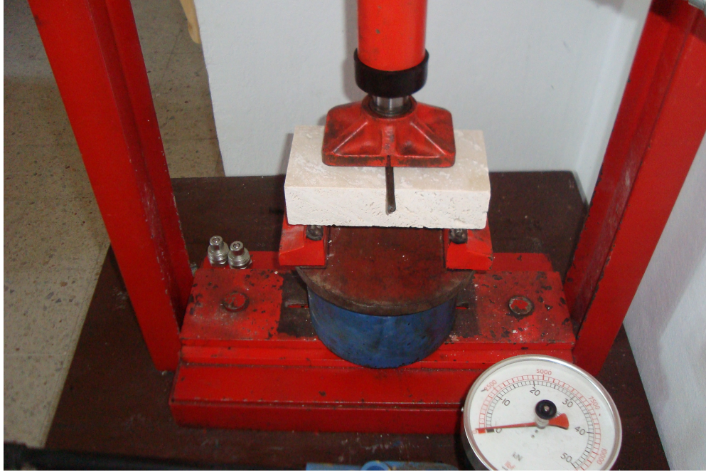
Şekil 3.20 Numuneye eğilme dayanımı deneyinde basınç uygulanarak ölçülmesi.
