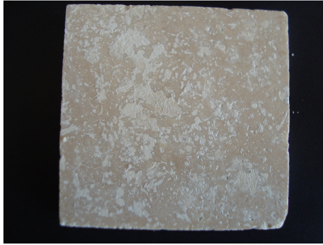
Şekil 4.19 (2. Karışım uygulanmış Light traverten numunesi.)
