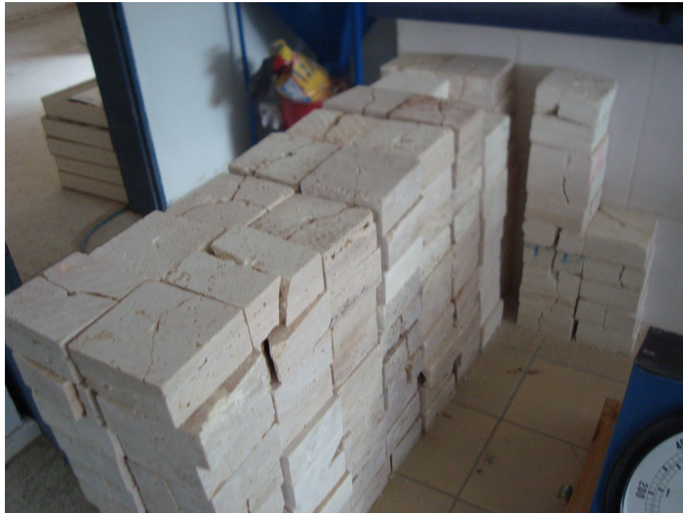
Şekil 3.10 Nokta yükleme deneyine maruz kalan numunelerin görüntüsü.
