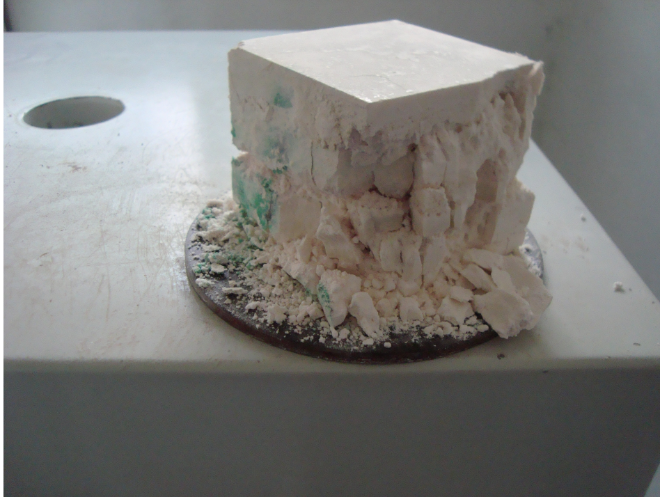
Şekil 3.13 Tek eksenli basınç dayanımını deneyine maruz kalmış bir numune.
