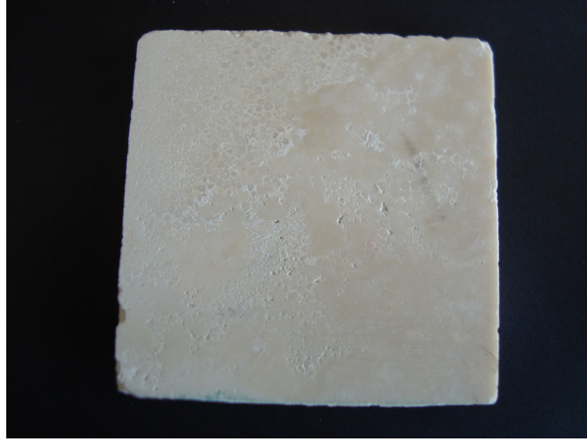
Şekil 4.21 (1. Karışım uygulanmış S.Light traverten numunesi.)
