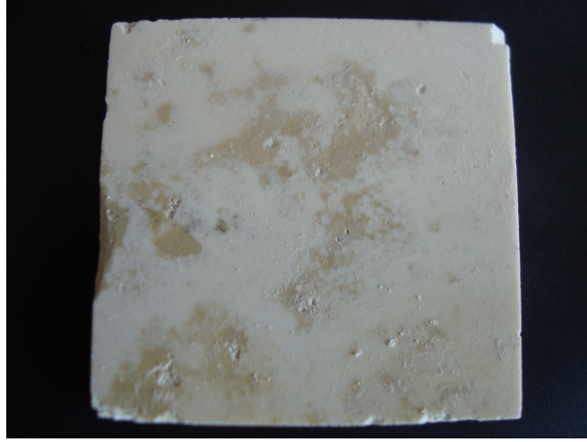
Şekil 4.24 ( 5. Karışım uygulanmış S.Light Traverten numunesi.)
