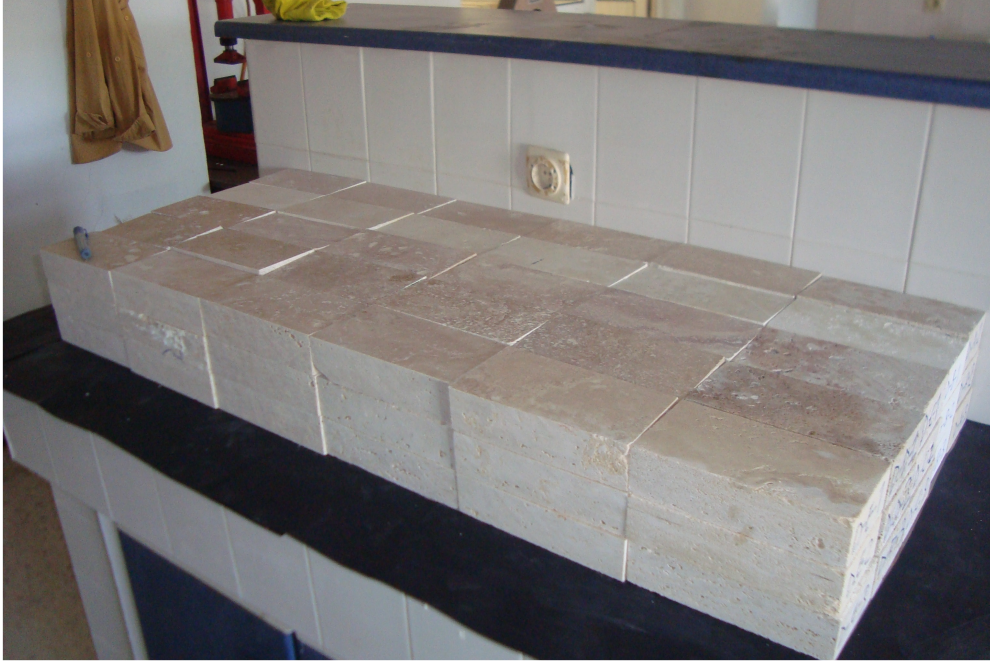
Şekil 3.18 Eğilme dayanımı deneyi için hazırlanan 5x10x15 cm 3 lük numuneler.
