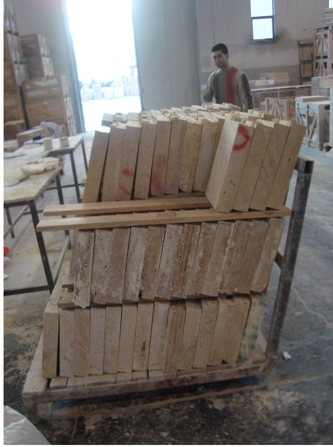
Şekil 3.2 Dolgudan çıkan numunelerin fırına verilmeden önce istiflenmesi.
