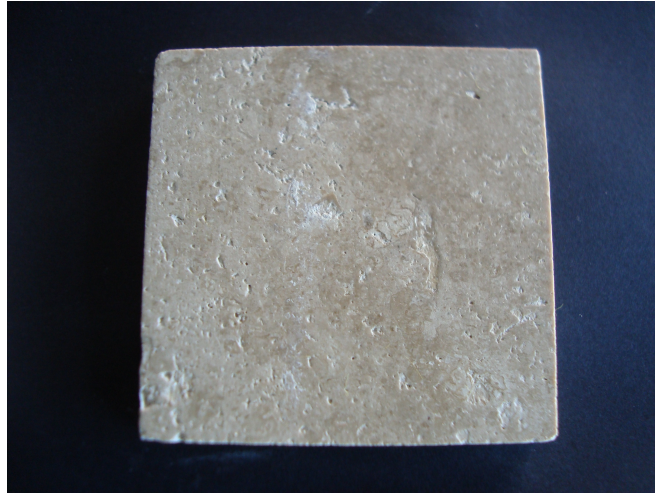
Şekil 4.34 (8. Karışım Uygulanmış Latte Traverten numunesi.)
