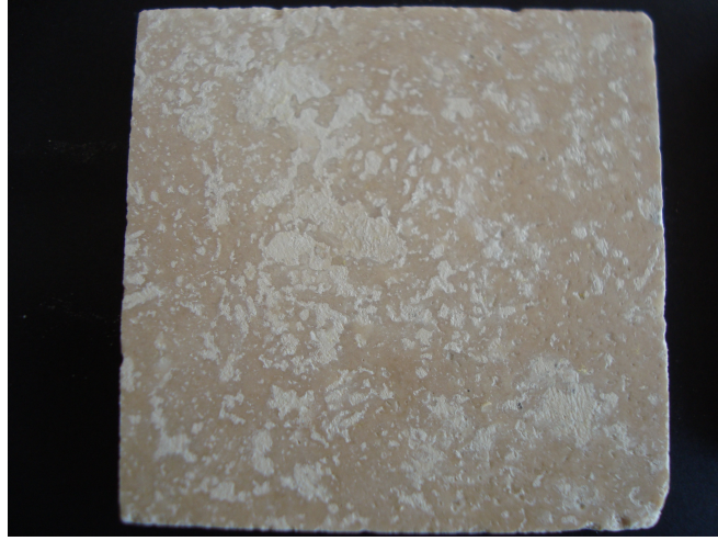
Şekil 4.27 (3. Karışım uygulanmış Light Traverten numunesi.)
