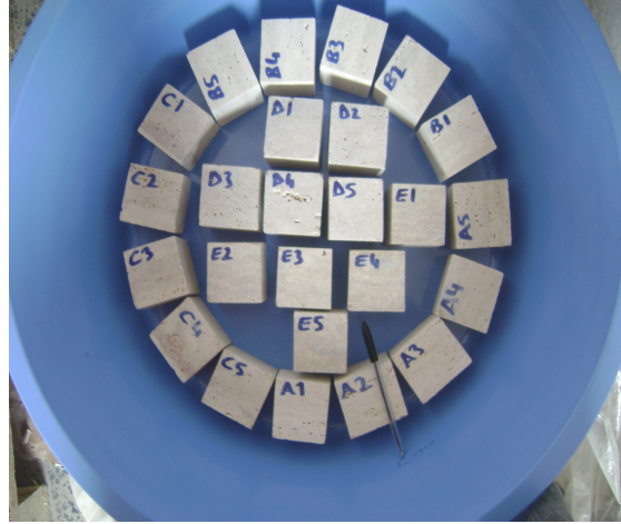
Şekil 3.6 Kak deneyinde Kullanılmak için hazırlanan numunelerin dizilmesi.
