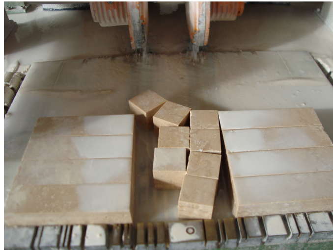
Şekil 3.3 Traverten Striplerin 7 \times 7 \times 7 \text{ cm}^3 lük numune haline getirilmesi.
