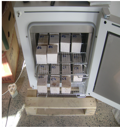
Şekil 3.8 Kak deneyinde kullanılan numunelerin kroyeye dizilişi.
