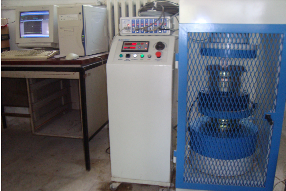
Şekil 3.22 Hazırlanan Karot numunelerin hidrolik presde değerlerinin okunması.
