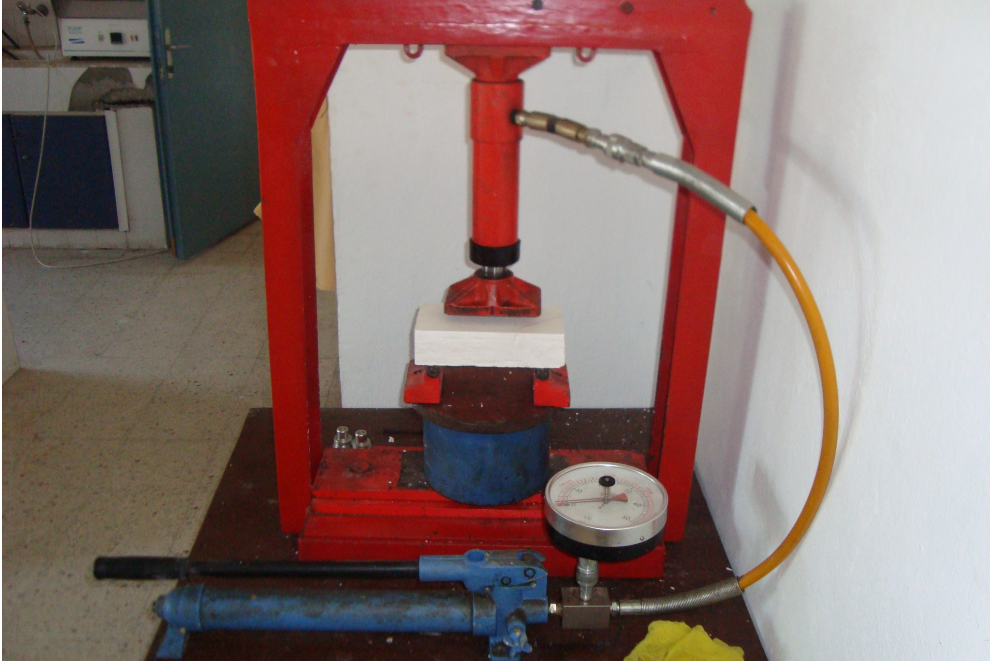
Şekil 3.19 Numunenin Eğilme dayanımında kullanılan deney aletine yerleştirilmesi.
