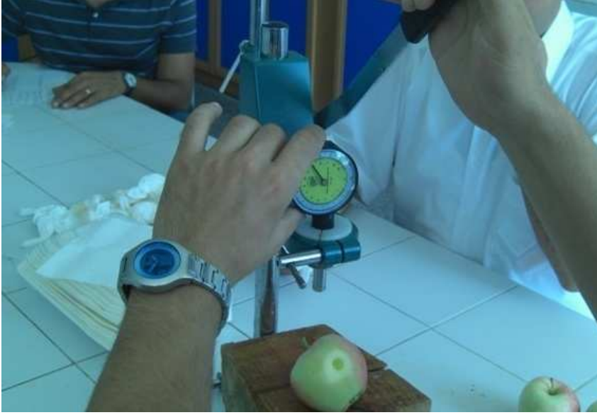
Şekil 4.7. Meyve eti sertliği ölçümü
