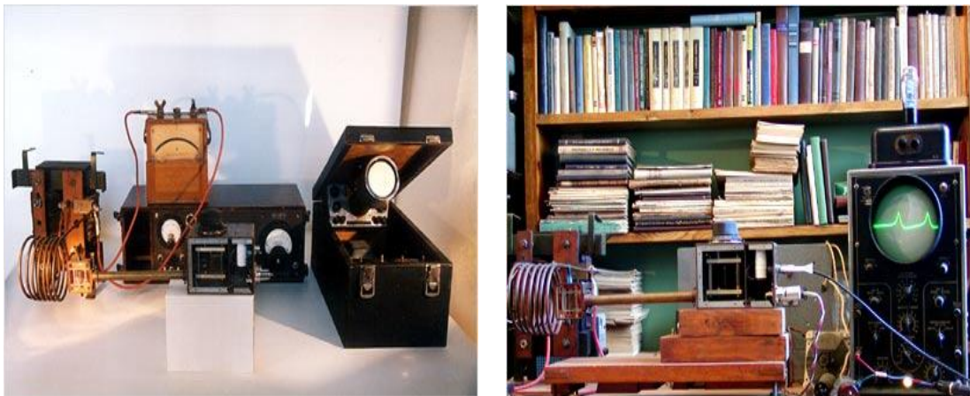
Resim 1.1 ESR sinyali gözlemlemek için yeniden düzenlenen ilk ESR cihazı ve bir ESR sinyalinin osilograf ekranında gösterimi
