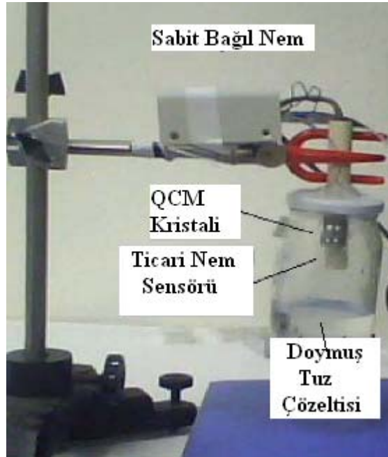
Şekil 4.1 Damlatma (drop casting) yöntemi ile yapılan deneylerin düzeni
