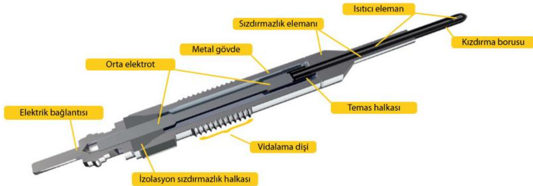
ekil 2.6. Bir seramik tipi ısıtma bujisinin genel yapısı
