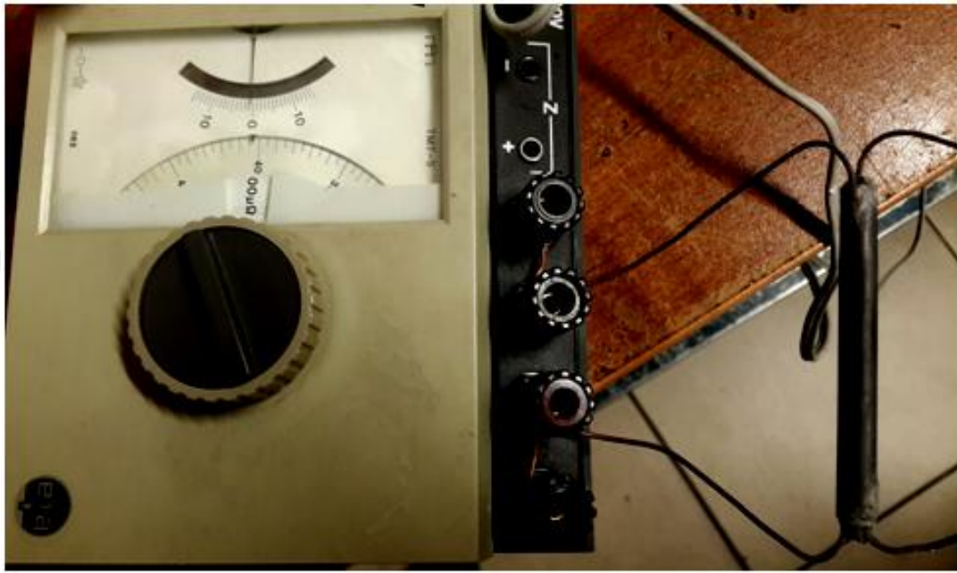
ekil 4.5. Isıtma bujisine ait iç direncin miliohm metre ile ölçülmesi
