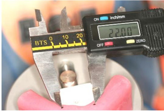
Resim 2.4. İmplantlar arası mesafe ölçümü
