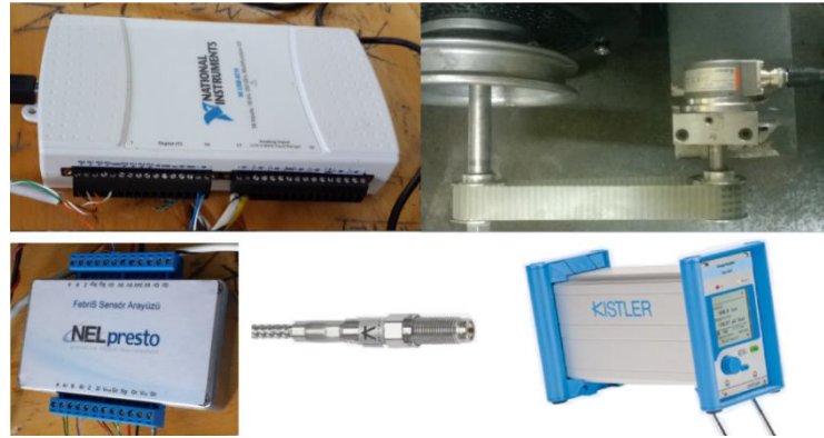
Şekil 3.11. Silindir basıncı ölçüm sistemi ekipmanları
