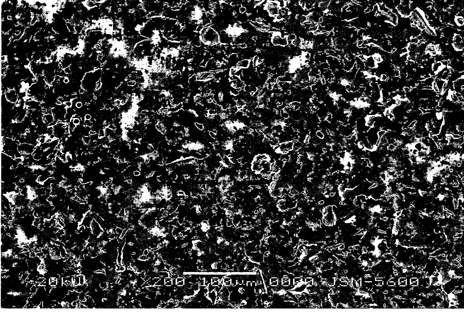
Resim 4.2. 125 µm alüminyum oksit ile pürüzlendirilmiş titanyum yüzeyin SEM görüntüsü (×200)
