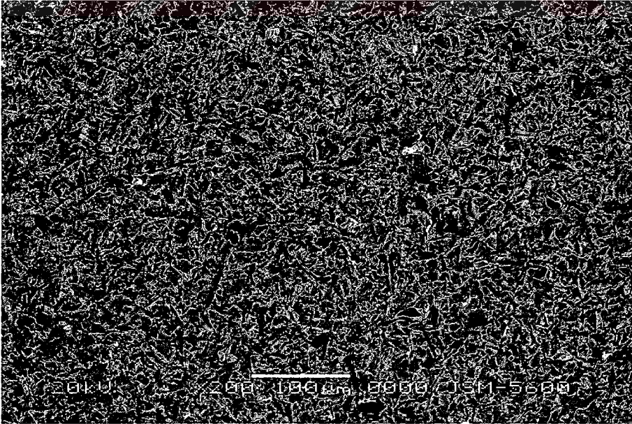
Resim 4.5. 50 µm alüminyum oksit ile pürüzlendirilmiş ve anodizasyon uygulanmış titanyum yüzeyin SEM görüntüsü (×200)
