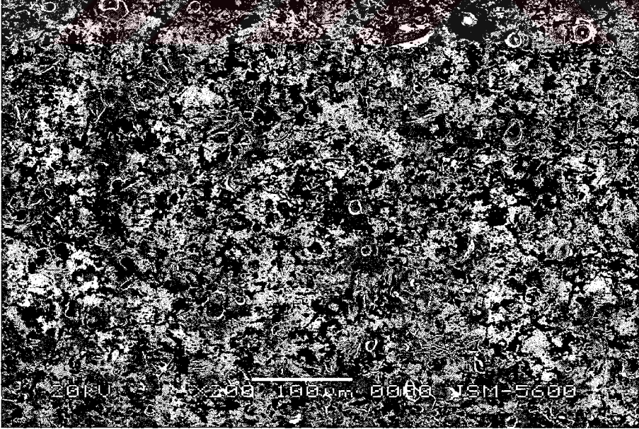
Resim 4.3. 125 µm alüminyum oksit ile pürüzlendirilmiş ve anodizasyon uygulanmış titanyum yüzeyin SEM görüntüsü (×200)
