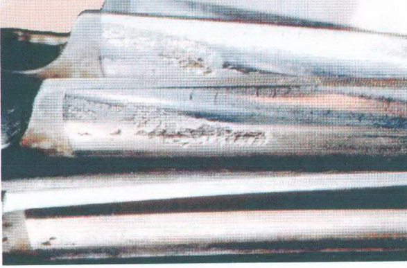
Şekil 4.11 Diş profili üzerinde mikropitting görünümü (Şahin ve İmrek 2001)
