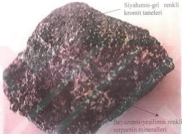
Şekil 7.1. Topraktepe (Yeşildağ) kromit cevherinin el örneğinde görünümü.
