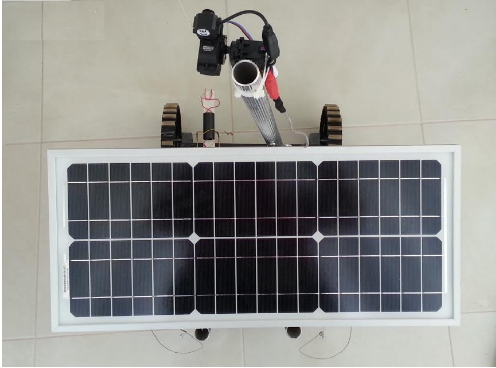
Şekil 4.11. Robotun üzerindeki güneş enerjisi paneli
