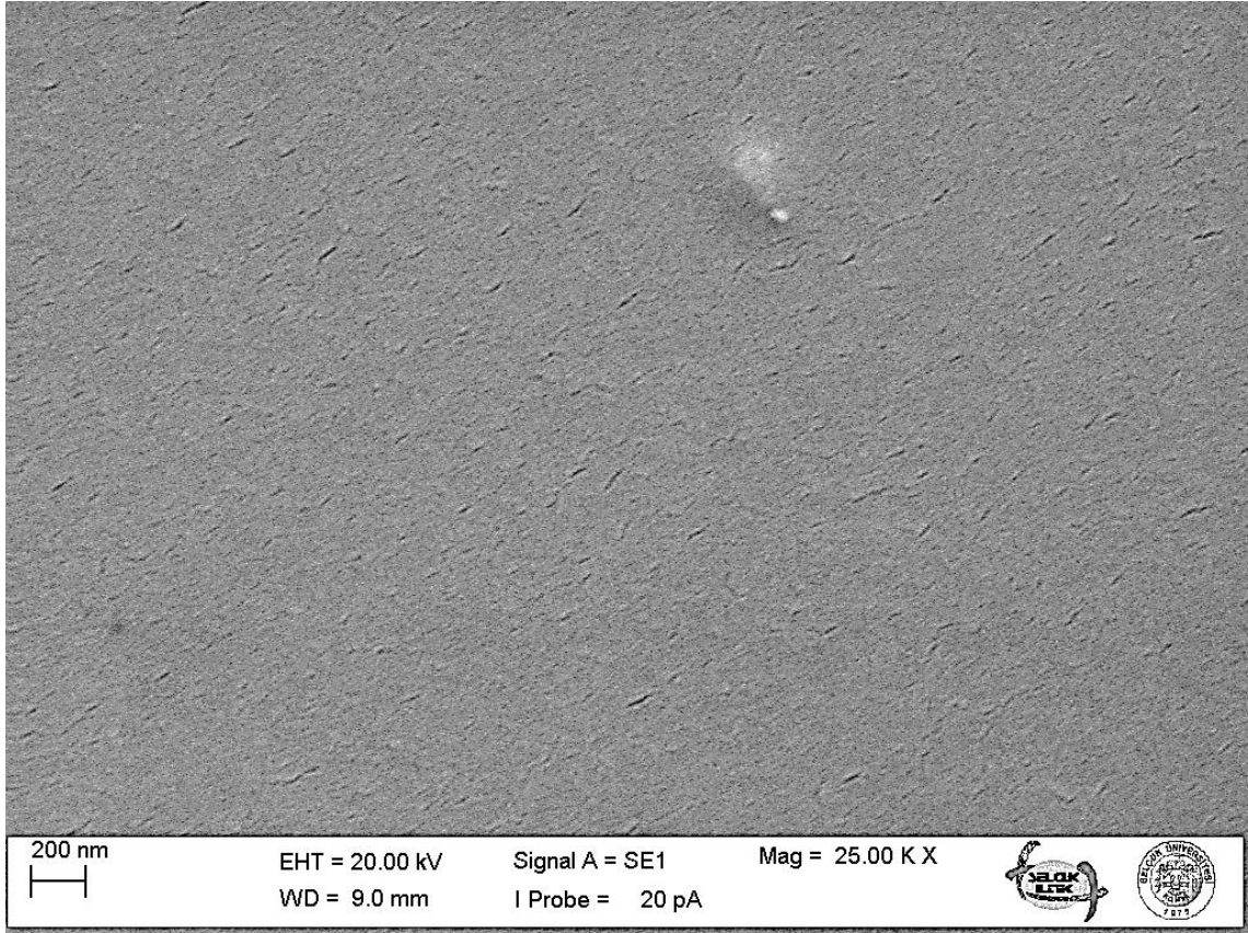
Şekil 5.6. Tavlanmış P3HT:PCBM tabakasının SEM fotoğrafı
