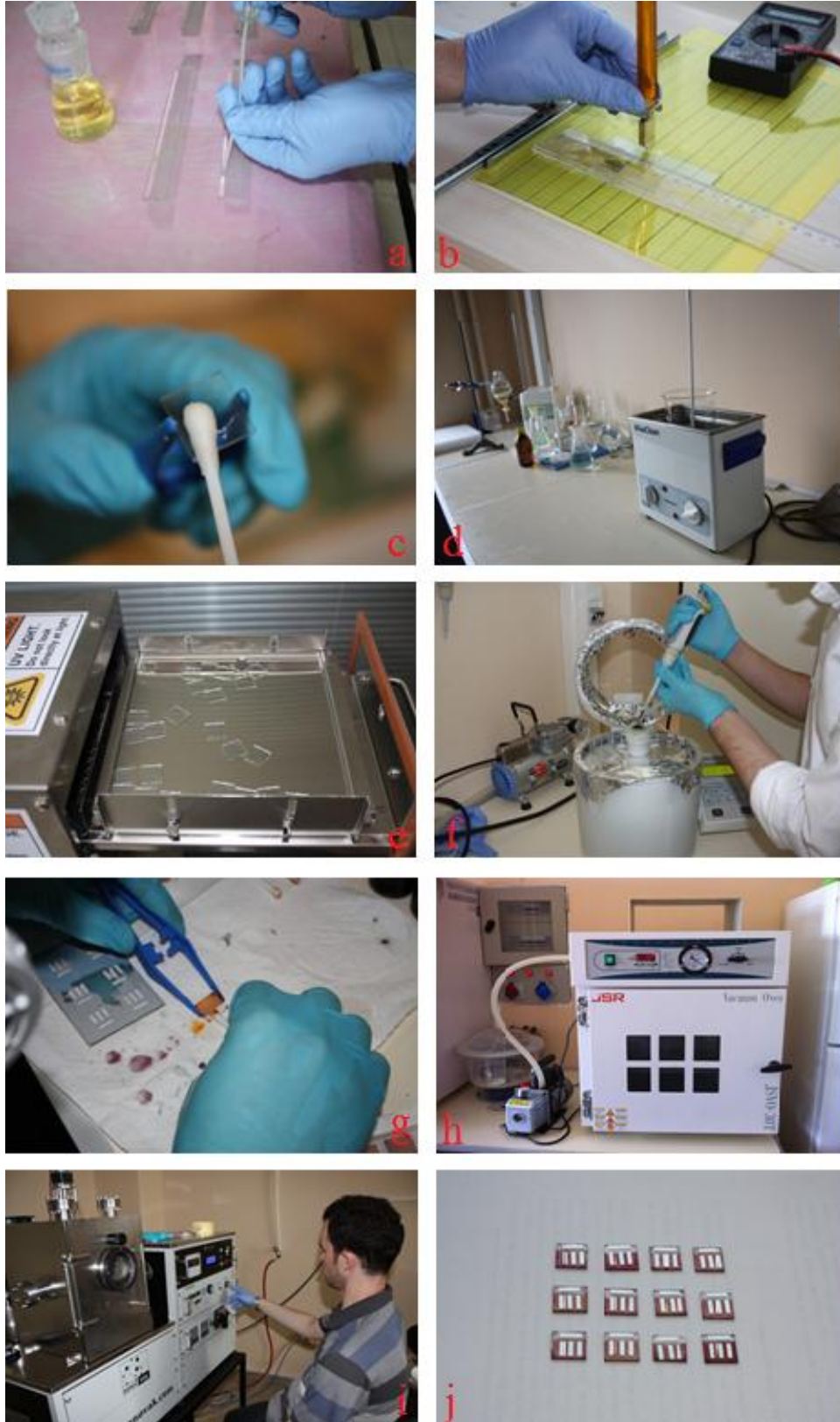
Şekil 4.10. Güneş pili yapım aşamaları
