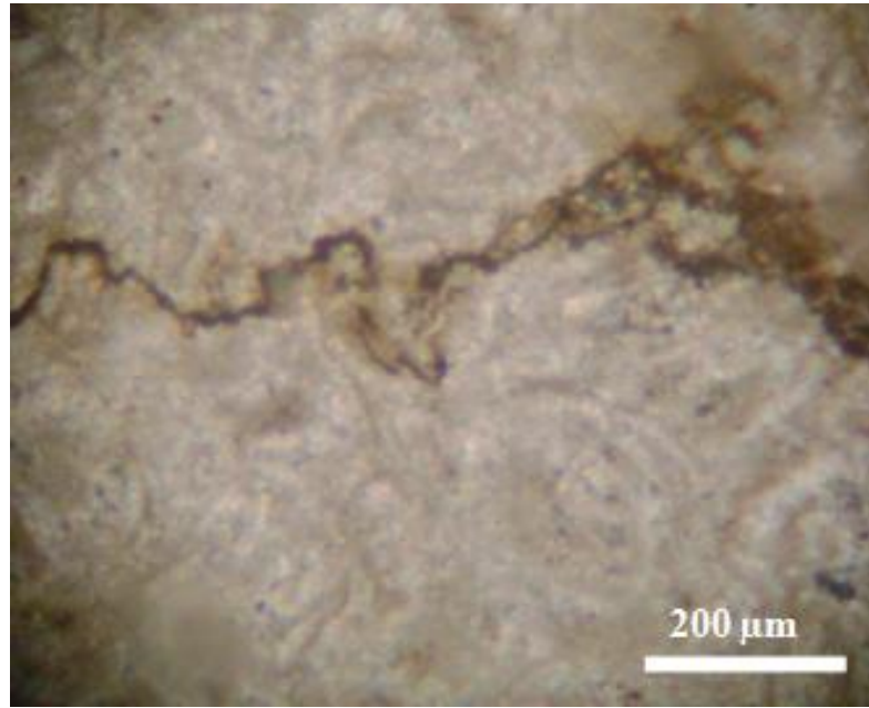
Şekil 3.44. Bol fosilli, sitilolitli kalsitik dolomit (Ç.N., Nu: B-83; kalsitik dolomit)
