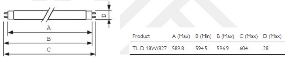
Şekil 3.4. Düşük renk sıcaklığına sahip flüoresanın boyutları (Philips, 2015b)
