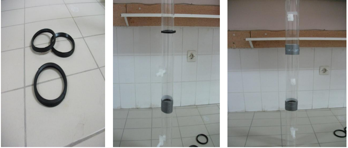
(a) (b) (c) Şekil 3.15. a) Sızdırmazlık contaları b) ve c) Contanın çevresinin bantla sabitlenmesi
