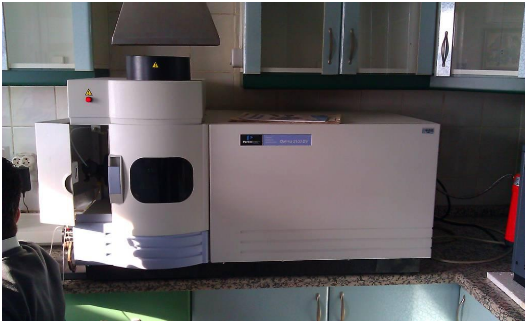
Şekil 3.24. Optima 2100 DV ICP-OES cihazı (PerkinElmer)
