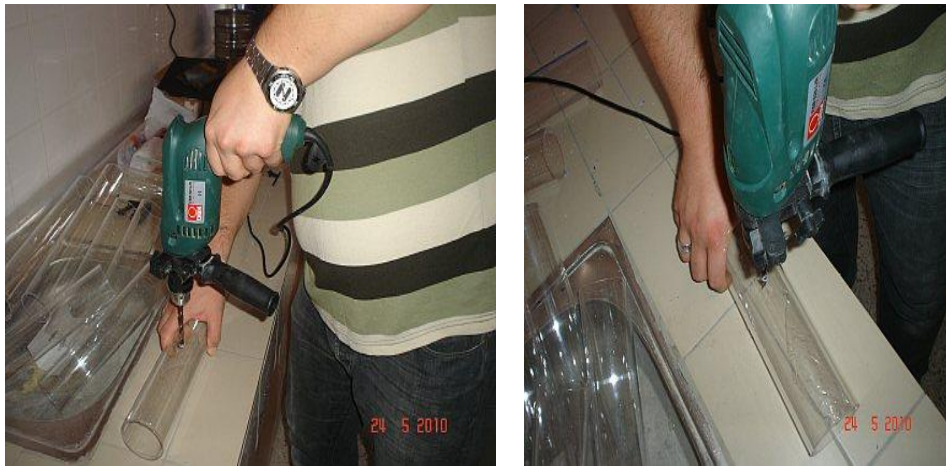
Şekil 3.13. 40-30-30 cm'lik 3 parçaya bölünen kolonların hazırlanması
