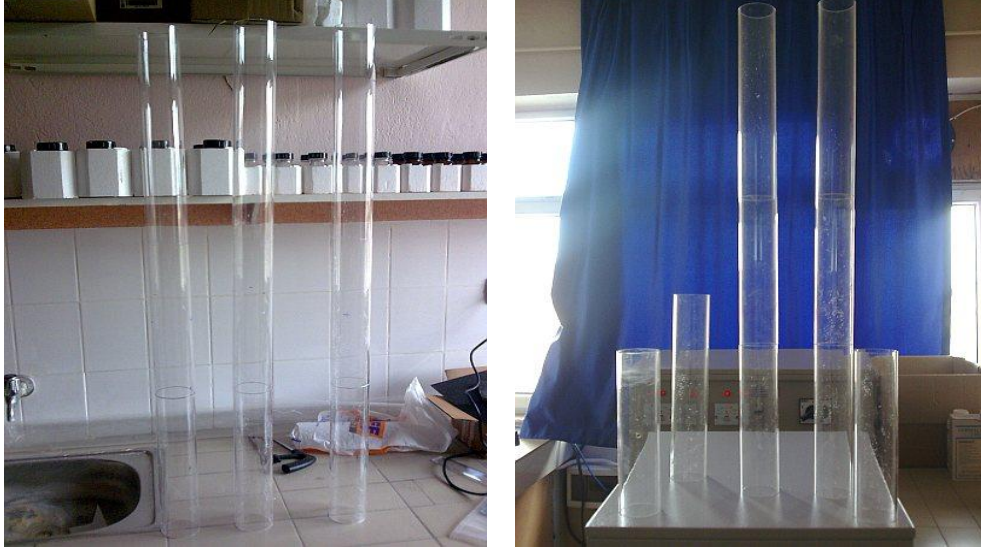
Şekil 3.14. 40-30-30 cm'lik deney düzeneği için hazırlanmış kolonlar
