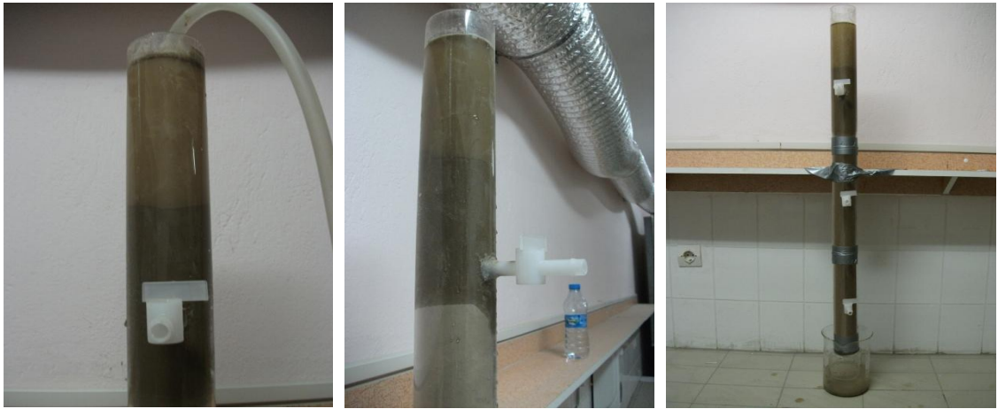
Şekil 3.16. Örnek bir kolonun yüklenmiş hali
