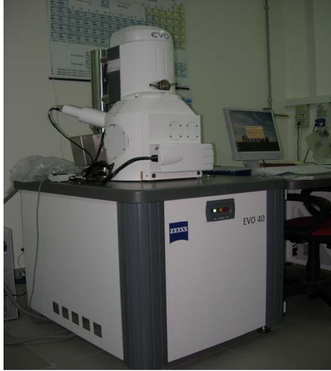
Şekil 3.9 ZEISS marka ve EVO 40 modelli taramalı elektron mikroskobu ve EDX aparatı
