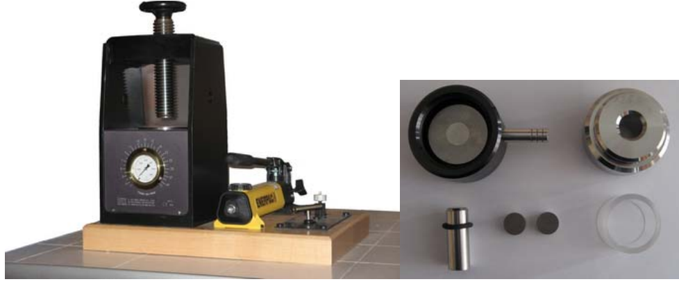
Şekil 3.4 Crystal Lab marka pres ve 13 mm çaplı KBr die seti.
