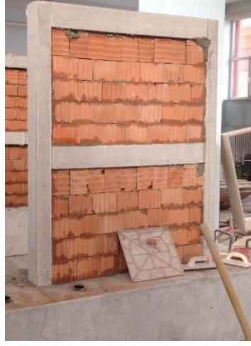
Şekil 3.14. Tuğla dolgu duvarlı betonarme çerçeve
