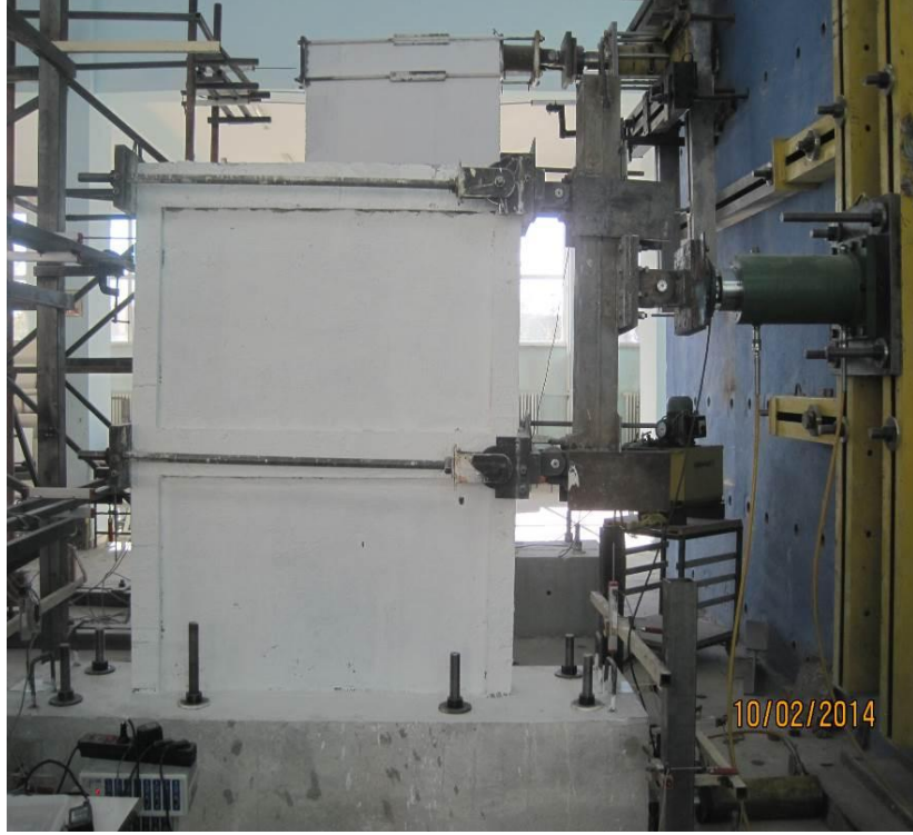
Şekil 3.25. Sıvalı tuğla dolgu duvarlı betonarme çerçevede kullanılan yükleme ve ölçüm düzeneği
