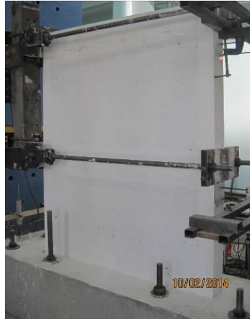
Şekil 3.16. Boyalı sıvanmış tuğla dolgu duvarlı betonarme çerçeve
