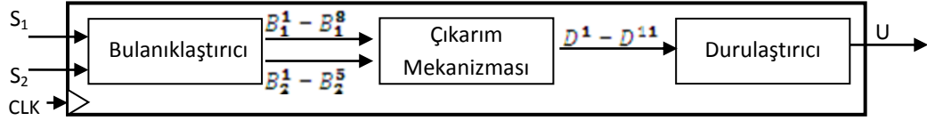
Şekil 5. VHDL ile tasarlanan bulanık kontrolör bileşenleri
