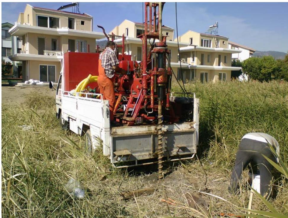
**Şekil 7.** Arazide SPT deneyine ait sondaj çalışması
