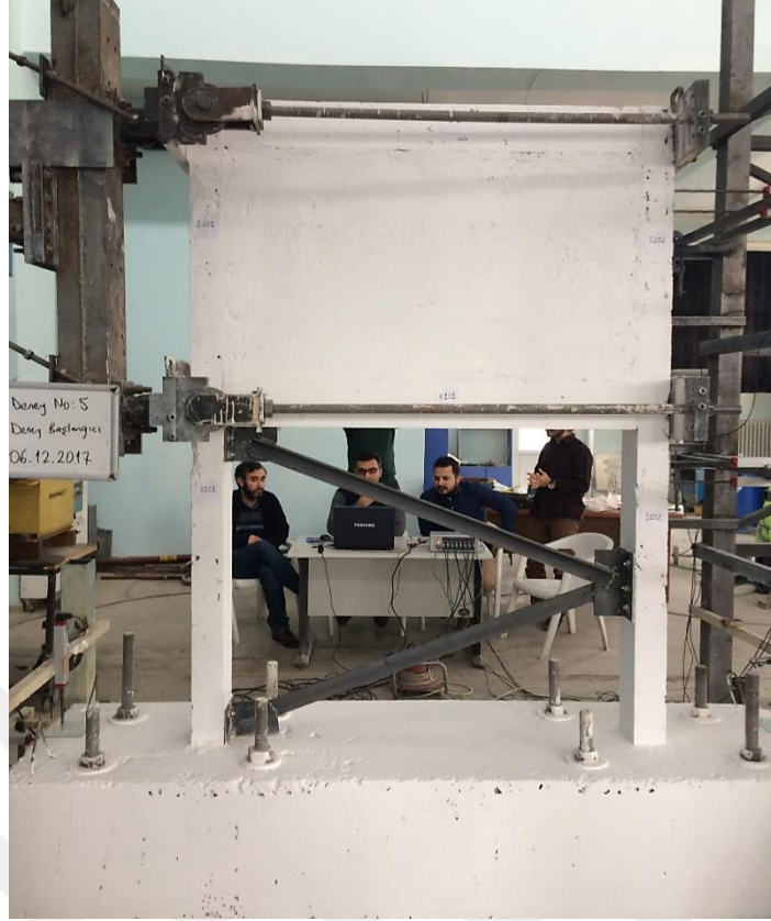
Şekil 4.22. Yan V-Tipi Çelik Çaprazlı (YVÇÇ) numunenin deney öncesi görünümü
