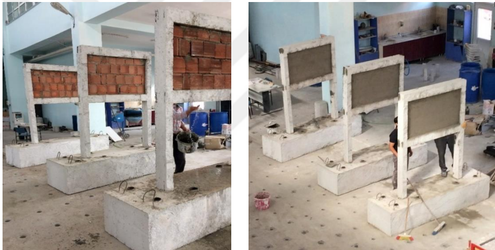
Şekil 3.13. Çerçevelerde dolgu duvar örümü ve sıvanması aşamaları
