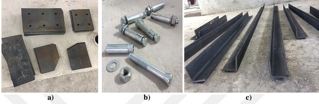
Şekil 3.14. Güçlendirme uygulamasında kullanılan malzemeler a) Plakalar, b) Ankraj Bulonları ve c) L-Profiller
