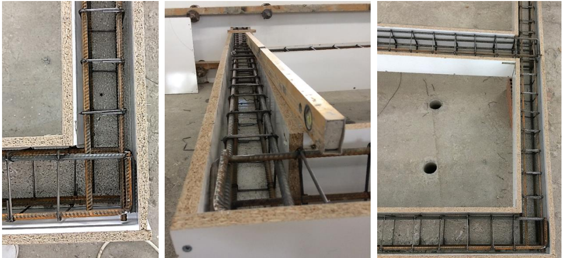
Şekil 3.4. Çerçeve birleşim bölgelerinin detayları
