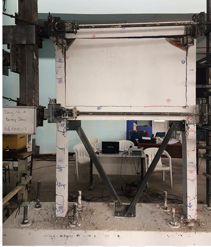
Şekil 4.16. Düz V-Tipi Çelik Çaprazlı (DVÇÇ) numunenin deney sonrası genel görünümü
