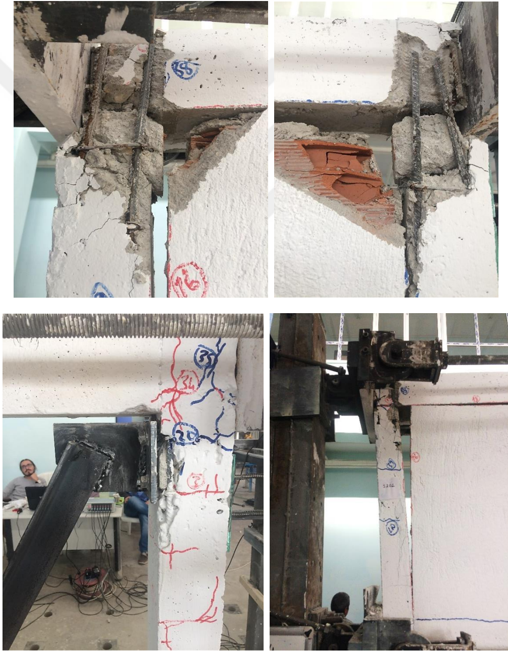
Şekil 4.19. Deney Sonunda DVÇÇ Numunesinde Görülen Ağır Hasarlar
