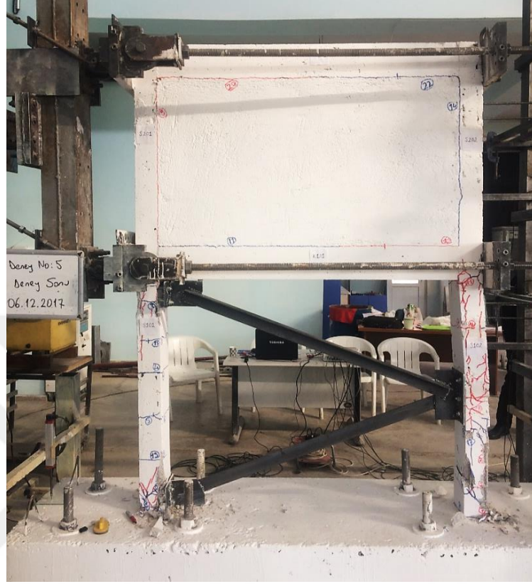
Şekil 4.26. Yan V-Tipi Çelik Çaprazlı (YVÇÇ) numunenin deney sonrası genel görünümü
