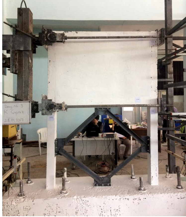
Şekil 4.1. K-Tipi Çelik Çaprazlı (KÇÇ) numunenin deney öncesi görünümü
