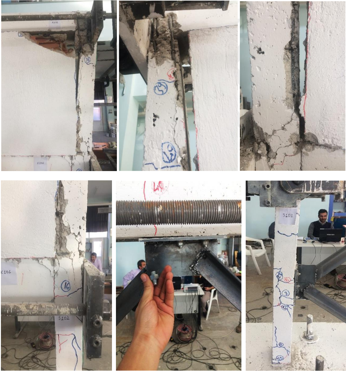
Şekil 4.9. Deney Sonunda KÇÇ Numunesinde Görülen Ağır Hasarlar
