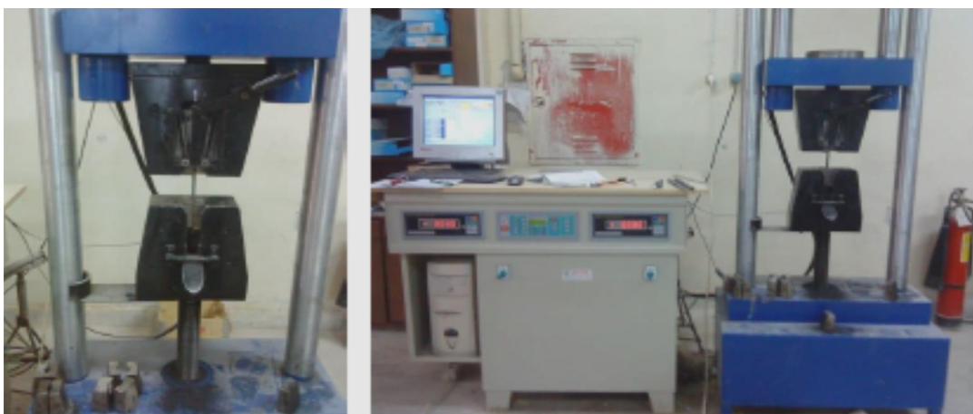
Şekil 3.6. S.Ü. İnşaat Müh. Böl. Yapı Malzemesi Laboratuvarında yapılan çelik çekme deneyi
