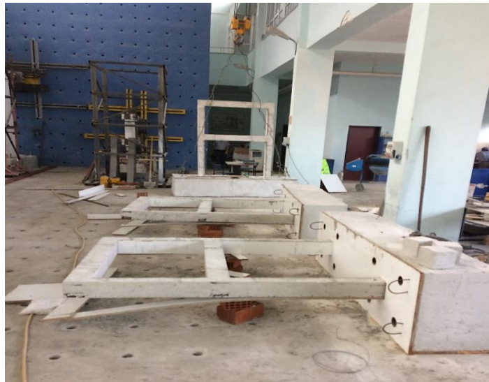
Şekil 3.12. Kalıpların sökülmesi ve numunelerin dikey konuma getirilmesi
