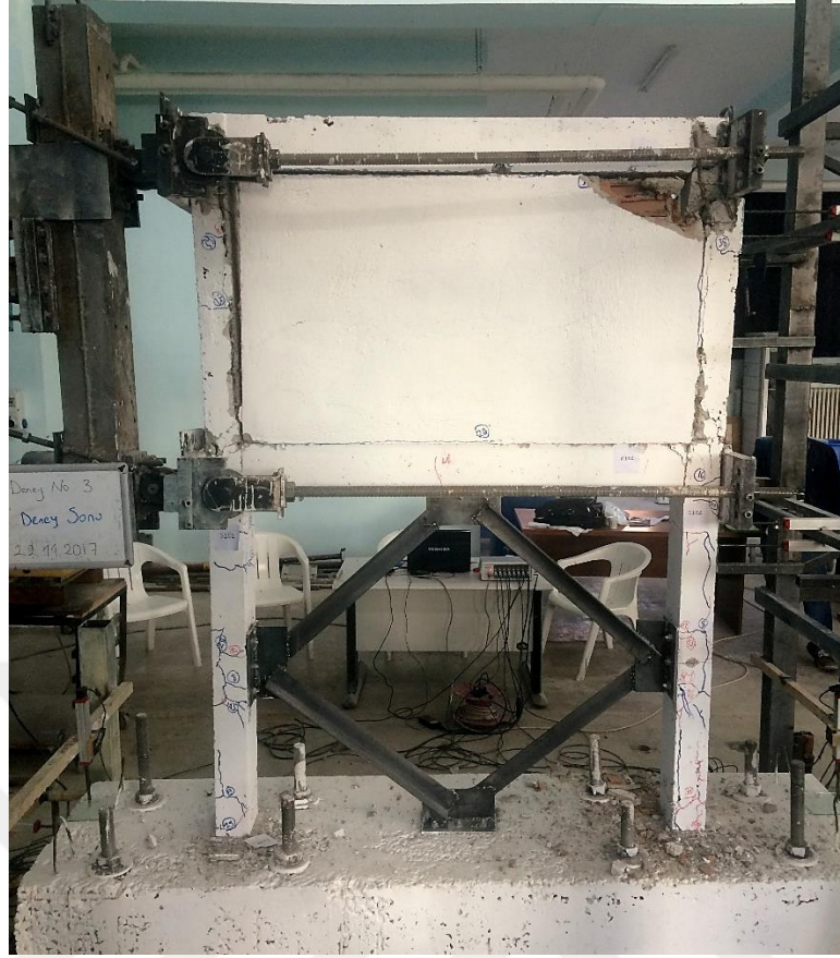
Şekil 4.6. K-Tipi Çelik Çaprazlı (KÇÇ) numunenin deney sonrası genel görünümü
