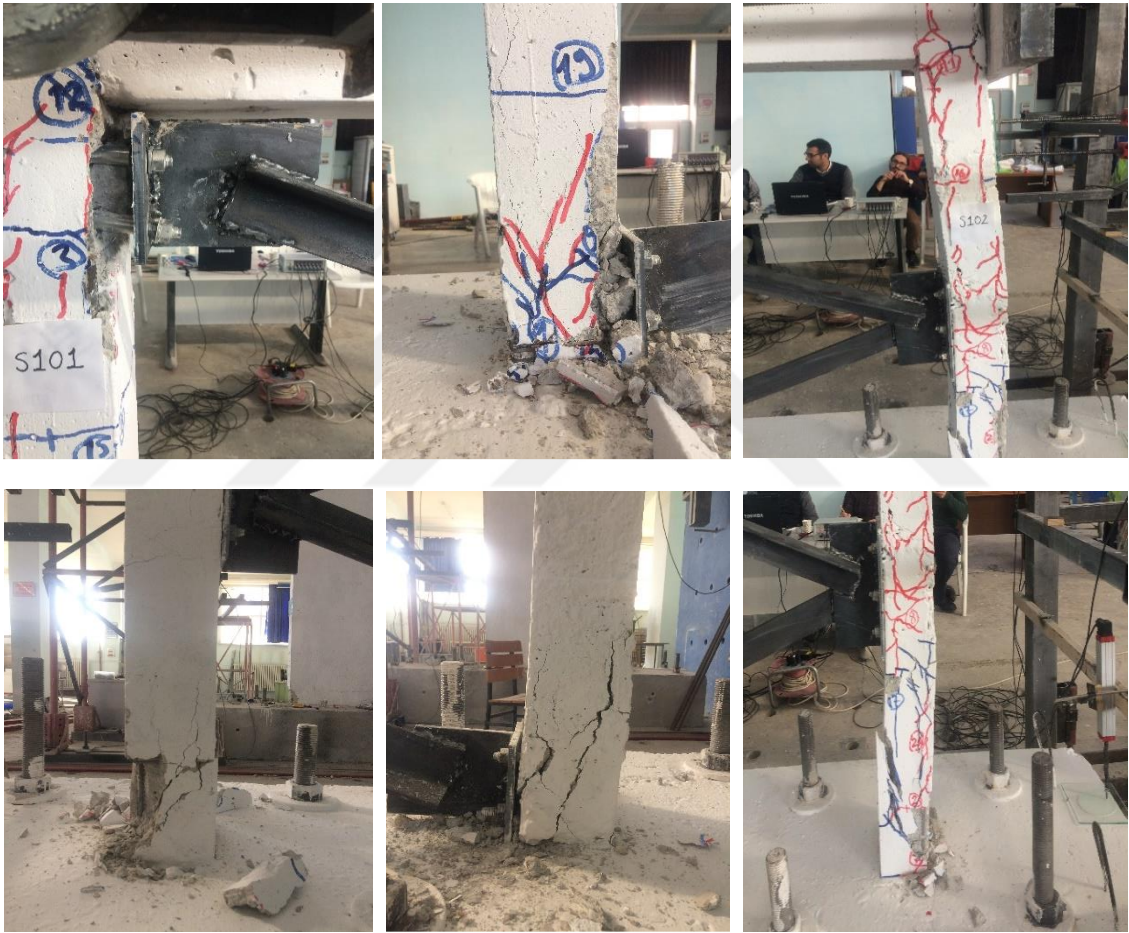
Şekil 4.29. Deney sonunda YVÇÇ numunesinde görülen ağır hasarlar
