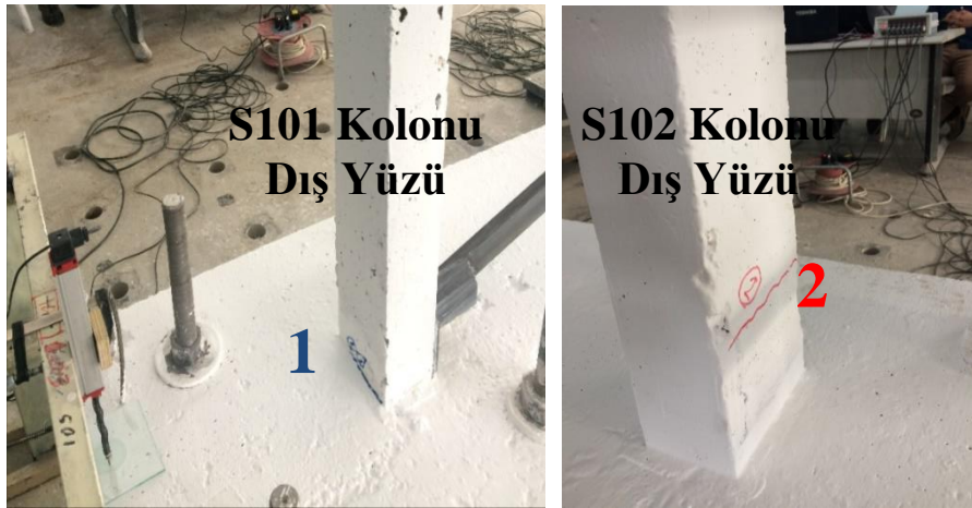
Şekil 4.25. Numunede oluşan ilk çatlaklar ( 2. Çevrim)
