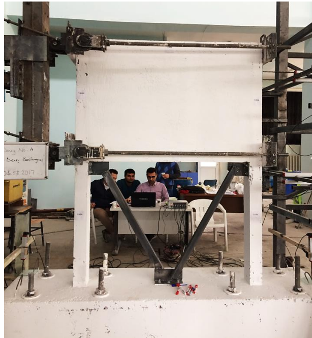
Şekil 4.12. Düz V-Tipi Çelik Çaprazlı (DVÇÇ) numunenin deney öncesi görünümü
