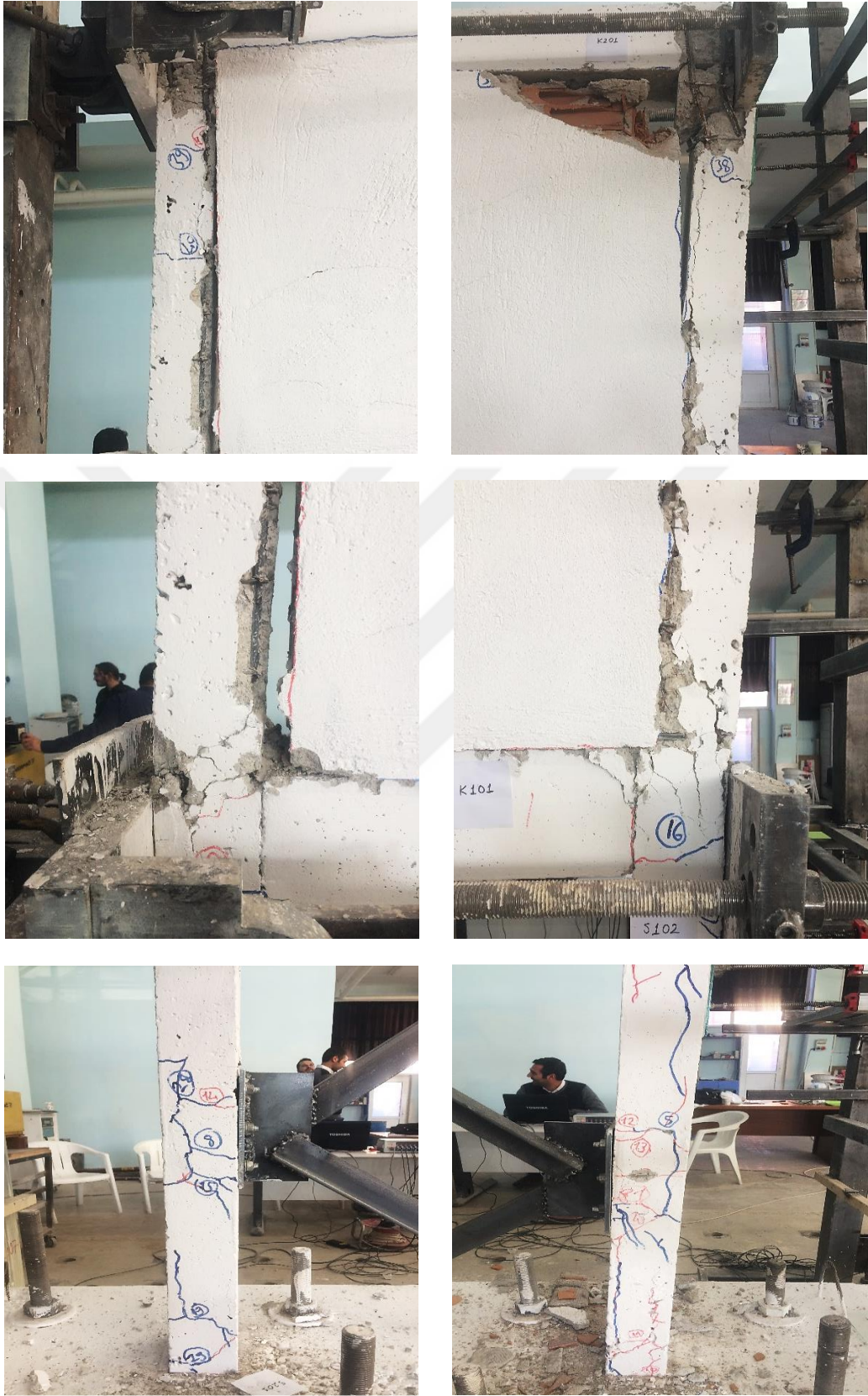
Şekil 4.8. K-Tipi Çelik Çaprazlı (KÇÇ) numunenin deney sonrası detay görünümü
