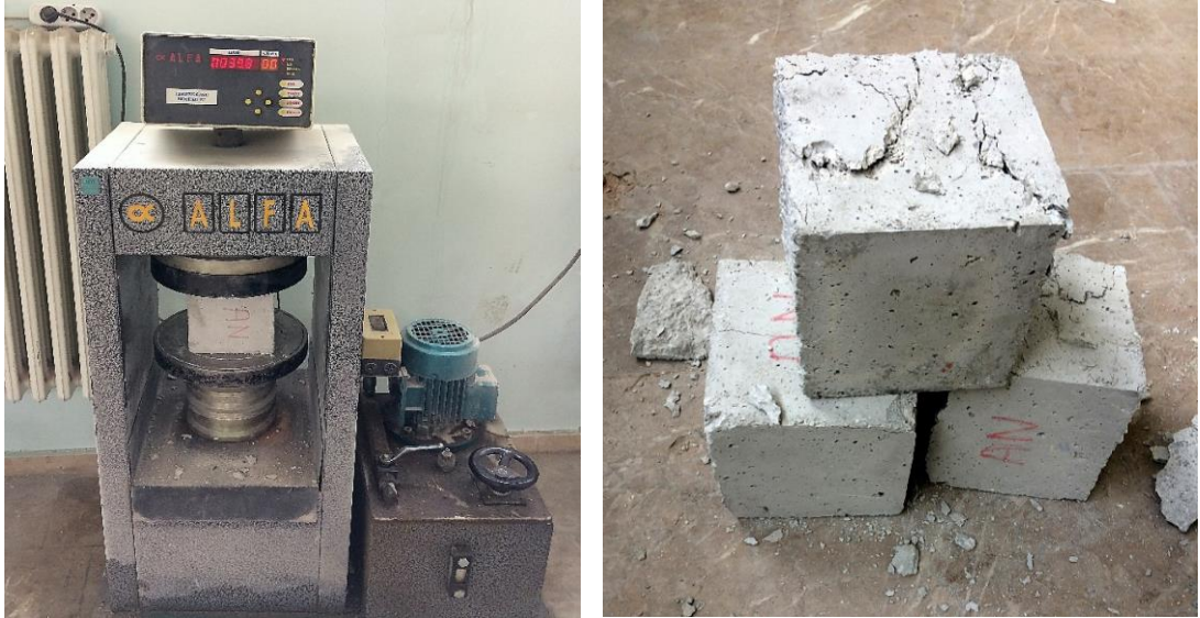
Şekil 3.5. Küp beton numunelerinde eksenel basınç testi ile dayanımların belirlenmesi
